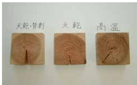
写真 13 高温人工乾燥によって生じた木材の内部割れ。
