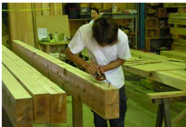
写真4 手刻み大工は自分で考えた加工設計図に基づいて構造材に加工のための線を引く。「加工設計図の作成→加工のための線を引く」という一連の作業を「墨付け」と呼ぶ。
